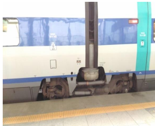
圖 3-50 為求輕量化與節省轉向架數量 轉向架安裝於車廂與車廂間
