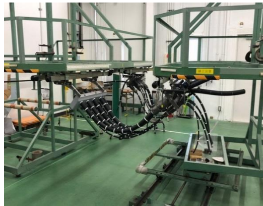
圖 3-36 跳線過彎偏倚試驗
