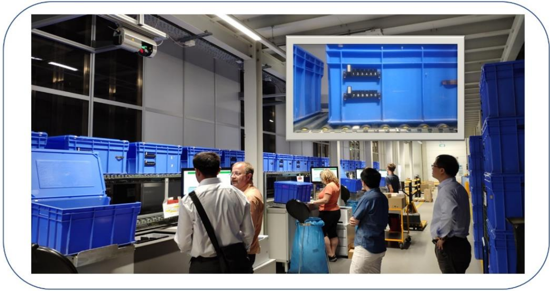
圖 30. 物流箱及 AUTOSTORE 系統之揀貨作業
