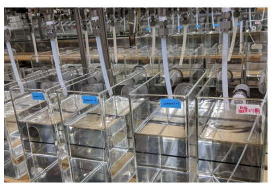
圖 6-17 與圖 6-18 新式的研究設備可自動偵測與補充試驗物，左圖使用光電分析試驗物濃度，右圖使用馬達定時加入新的試驗物。（攝於 NIES）
