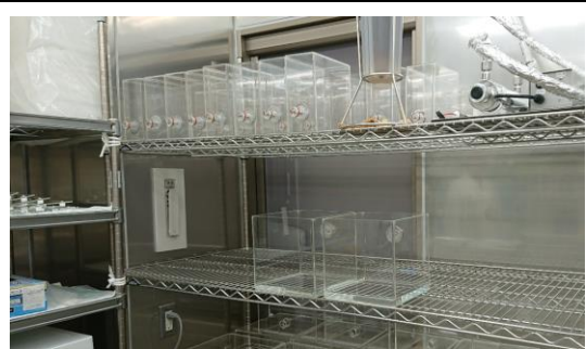
圖 6-19 更換水槽過程（曝氣與調節溫度）（攝於 NIES）
