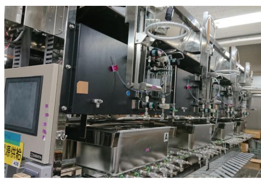
圖 6-17 與圖 6-18 新式的研究設備可自動偵測與補充試驗物，左圖使用光電分析試驗物濃度，右圖使用馬達定時加入新的試驗物。（攝於 NIES）
