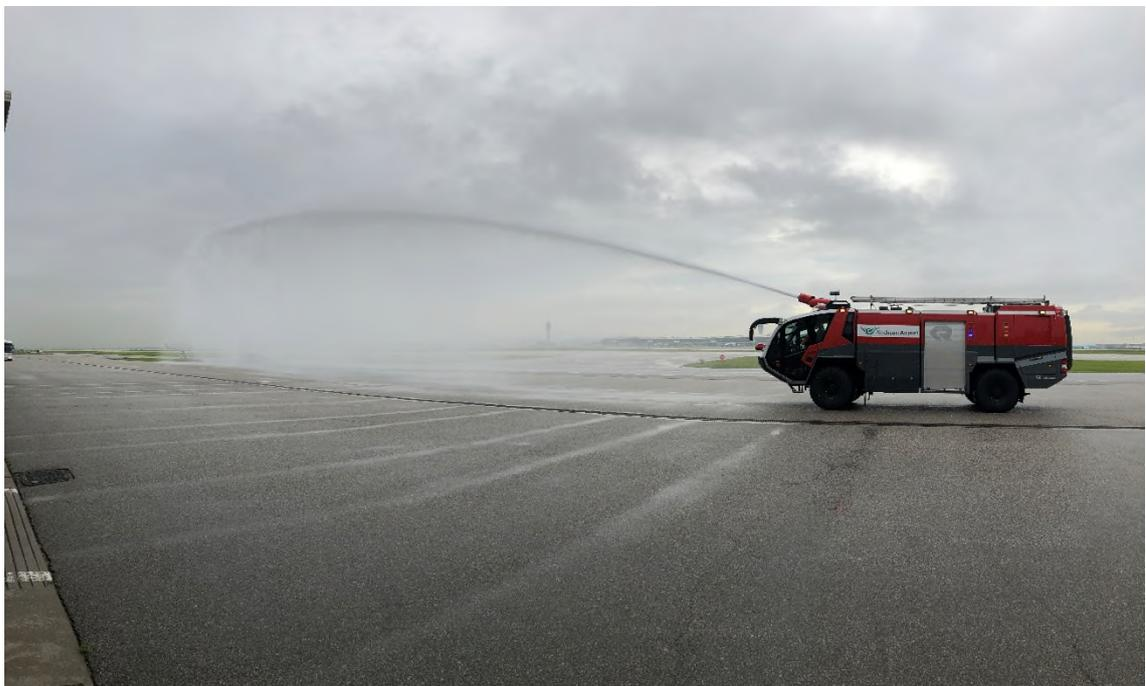
機場專用消防車展示，其水箱側面有大型燈號可以辨識水箱水量
