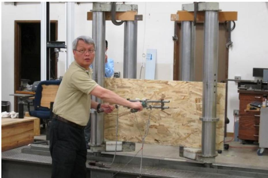
圖33 葉博士講解板材之剪力破壞試驗
