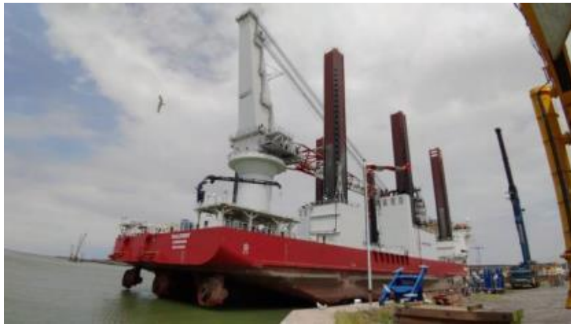
圖 14：TAILLEVENT 號為檢修需在港內抬升船體(已可見船尾螺旋槳)
