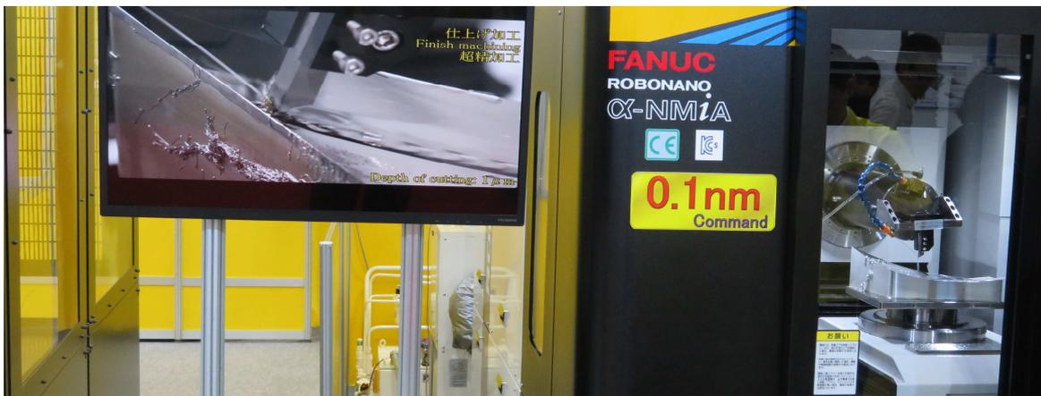
ROBONANO  $\alpha$ -NmiA 精密加工表面非常光滑，可應用在無法拋光加工需求
