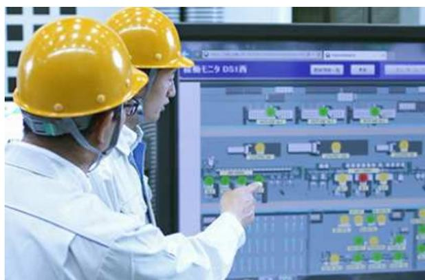
可視化機台監控系統，即時顯示機台稼動能力(摘錄自 OKUMA 官網)。
