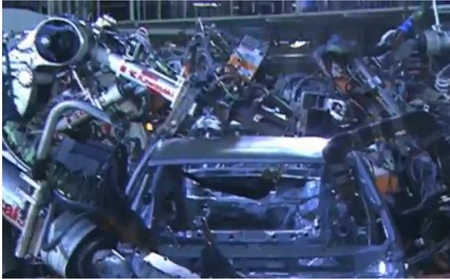
焊接車間使用機器人進行零件焊接(摘錄自 TOYOTA 官網)。
