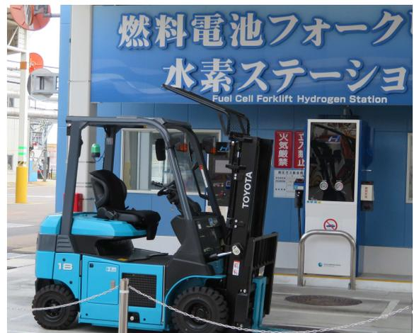
元町工廠使用氫燃料電池的堆高機進行搬運作業，圖為加氫站。
