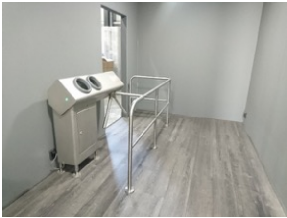
入口消毒設備
