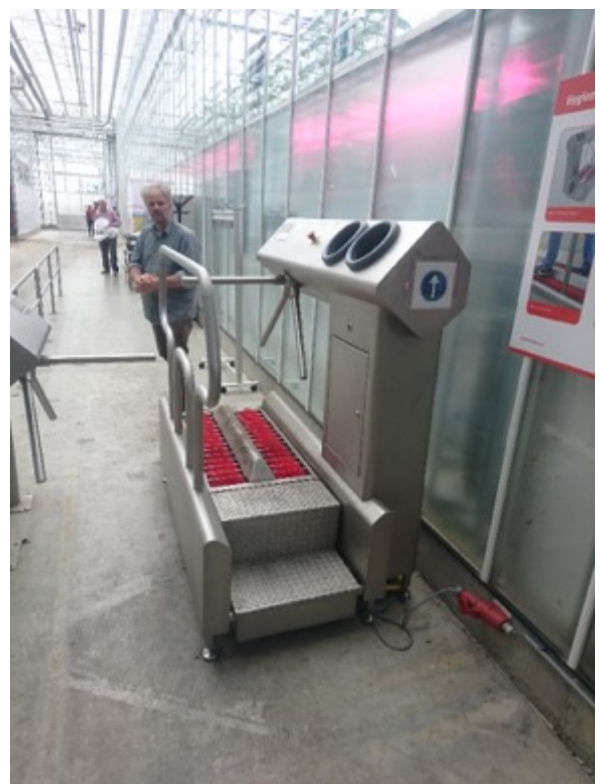
入口消毒設備
