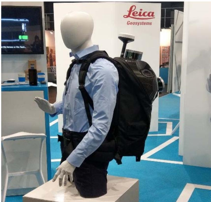
圖 46、現場展示人員背負式 GPS 測量設備
