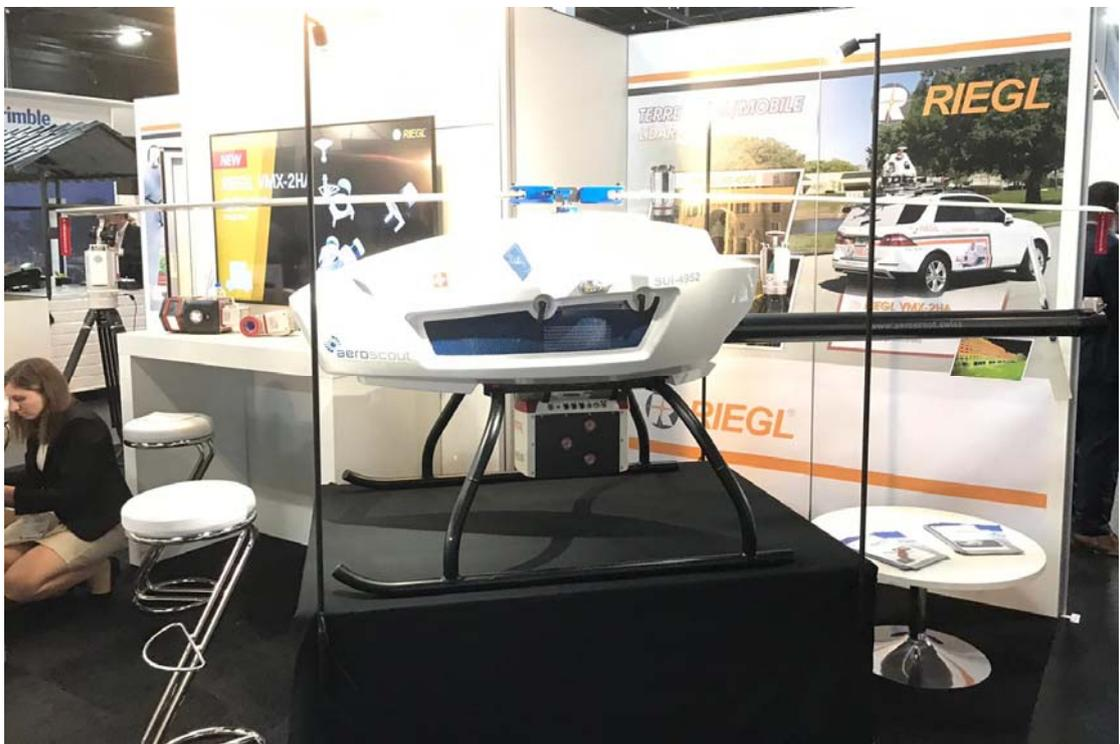
圖 44、廠商現場展示無人飛機（UAV）載光達（LiDAR）設備
