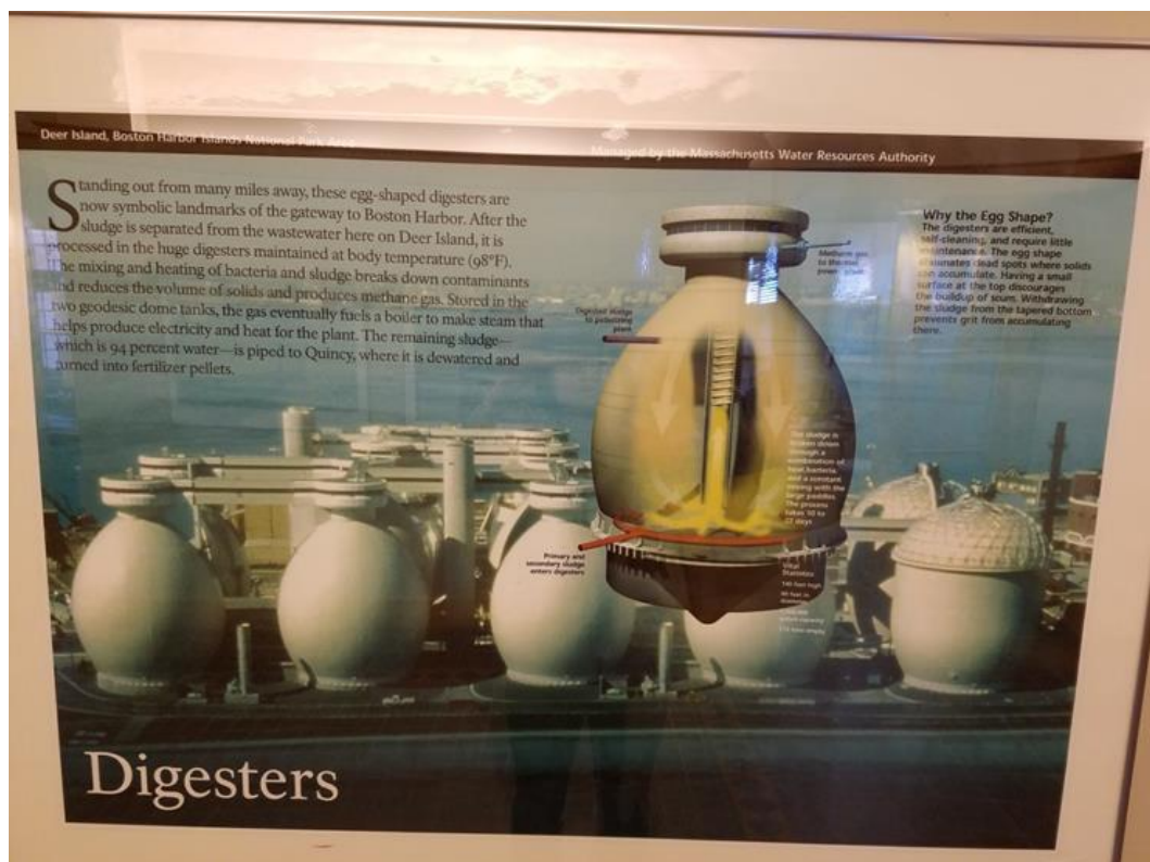
圖 10 蛋形厭氧消化槽(Egg-shaped anaerobic digesters)示意圖
