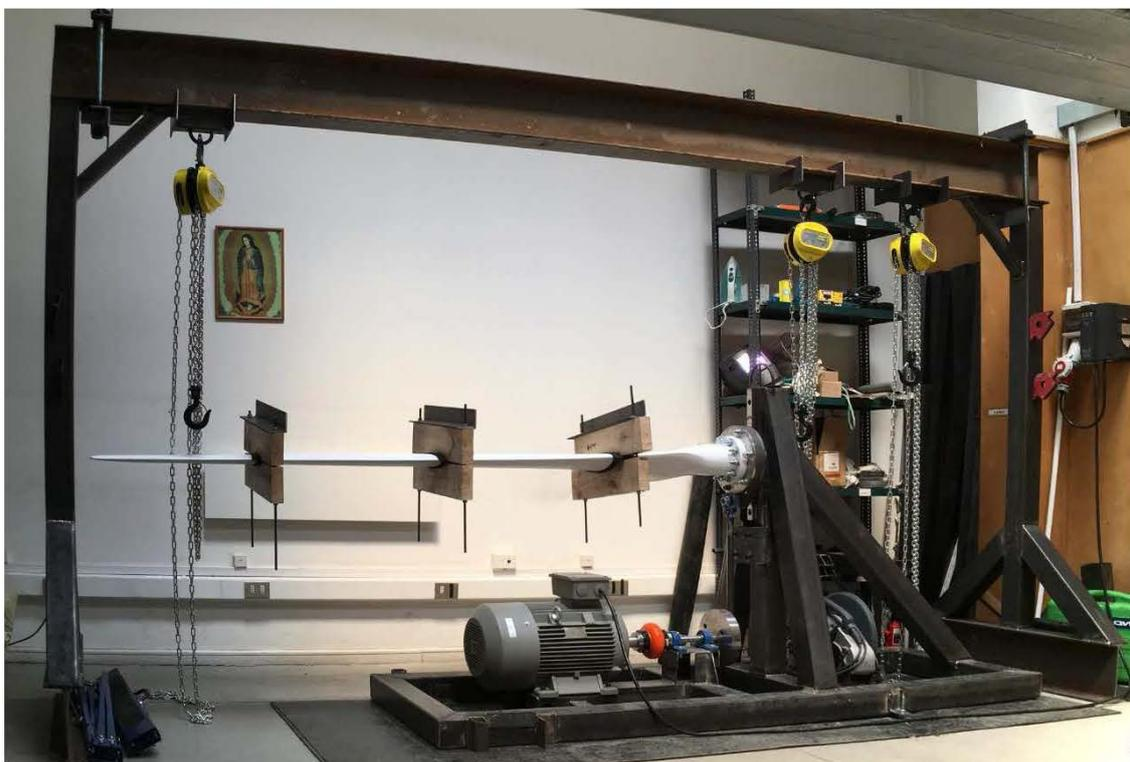
圖 2：小型風力發電機葉片進行靜態和動態試驗
