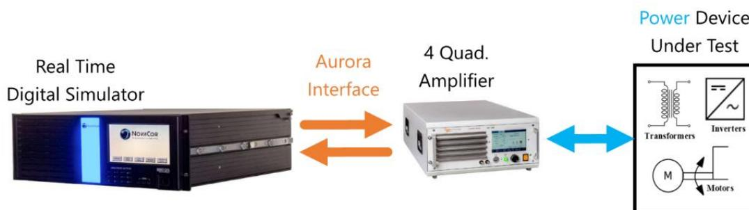
圖 18 功率級硬體閉迴路通信介面架構圖
