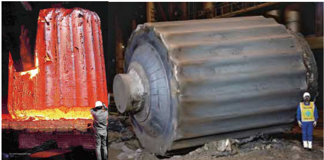
照片 4-3:世界最大之 600 噸(左)及 670 噸(右)鋼錠
