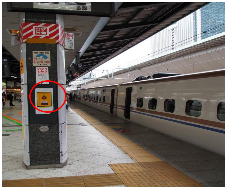
圖 48 任何人發現有立即危險都可以按下月台列車緊急停止按鈕停下列車
