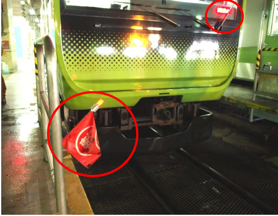
圖 27 車輛整備時於駕駛室外顯示移動禁止燈號、車頭旁掛上紅旗
