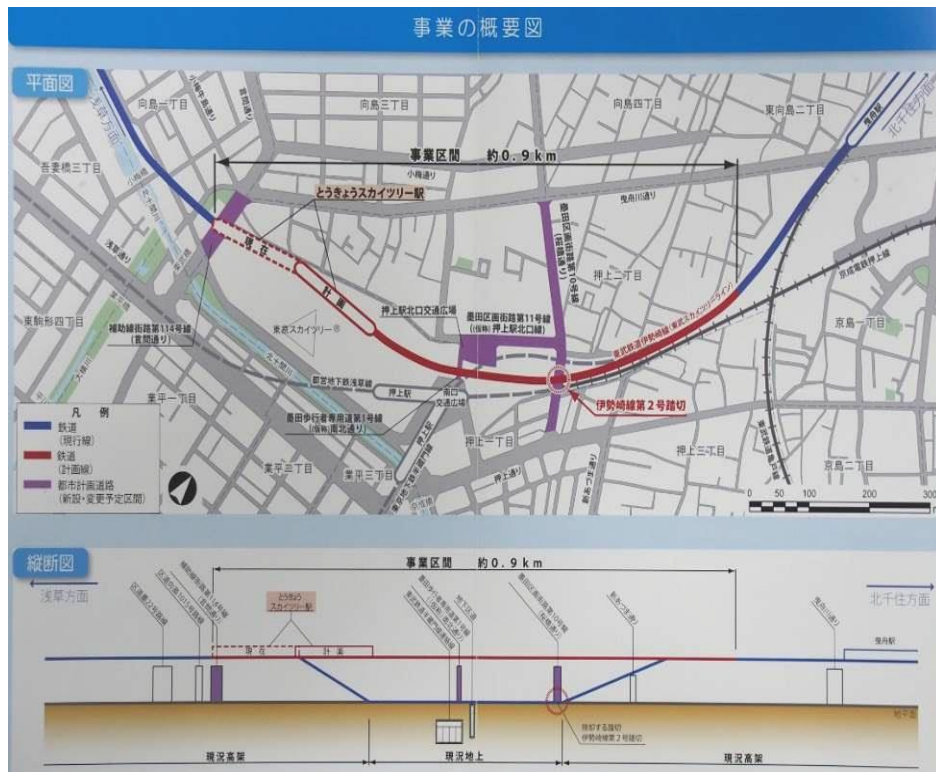
圖 46 押上站高架化工程概要圖
