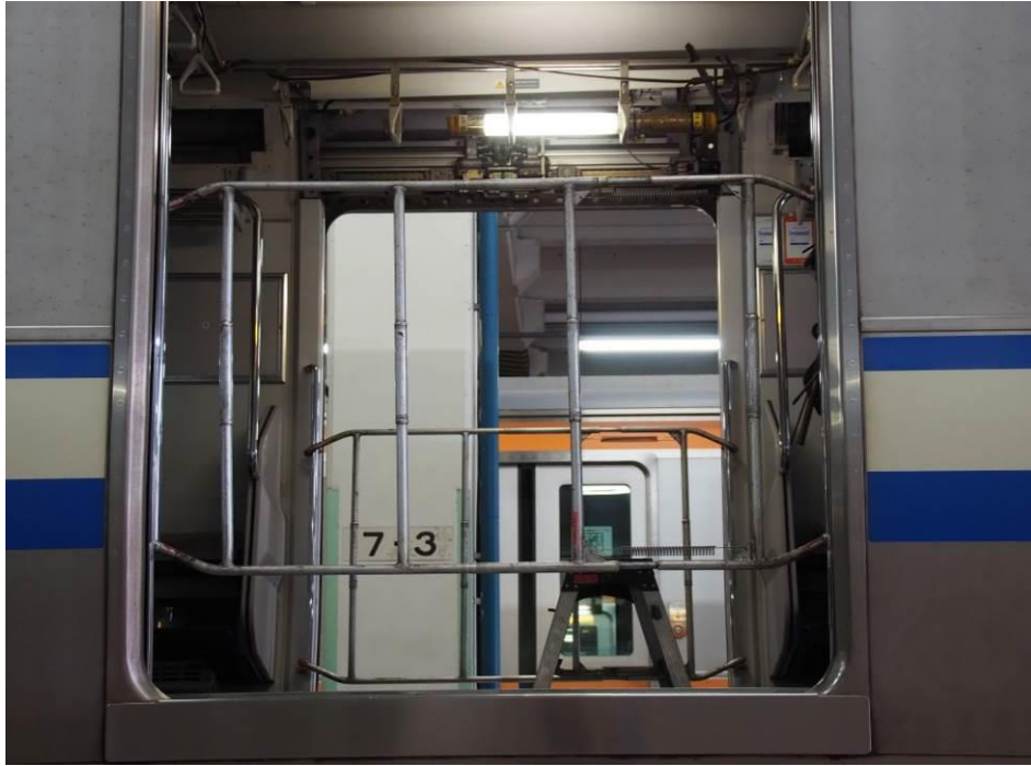
圖 33 車門開啟狀態下維修於車門設置臨時護欄
