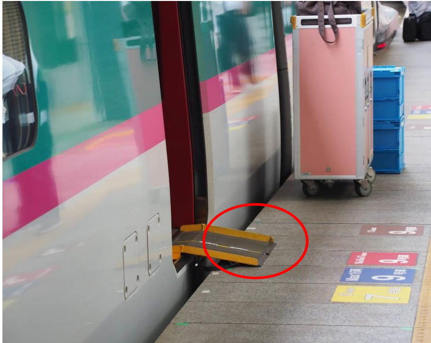
圖 52 車廂與月台間之小渡板，清潔人員及隨車服務人員工作推車經過車廂月台間順暢安全
