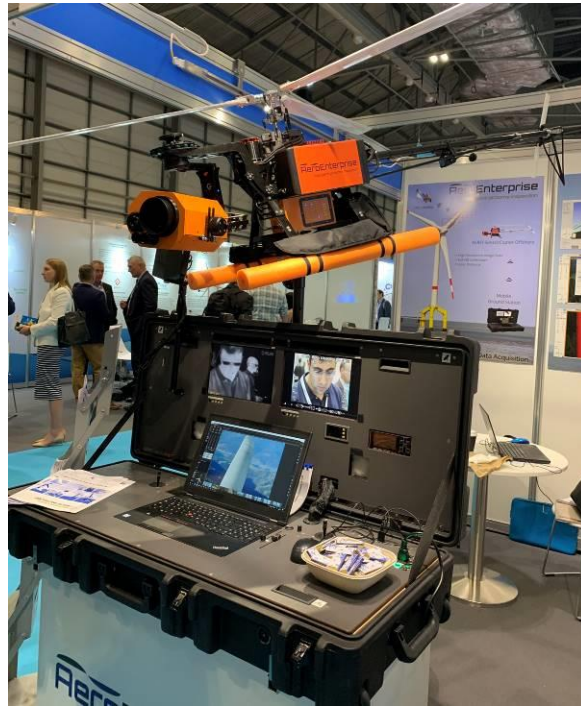
圖 32：Rero Enterprise 展示無人機風力機運維設備
