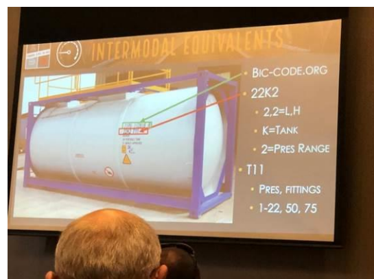
D.ISO Tank 槽體標示意義
