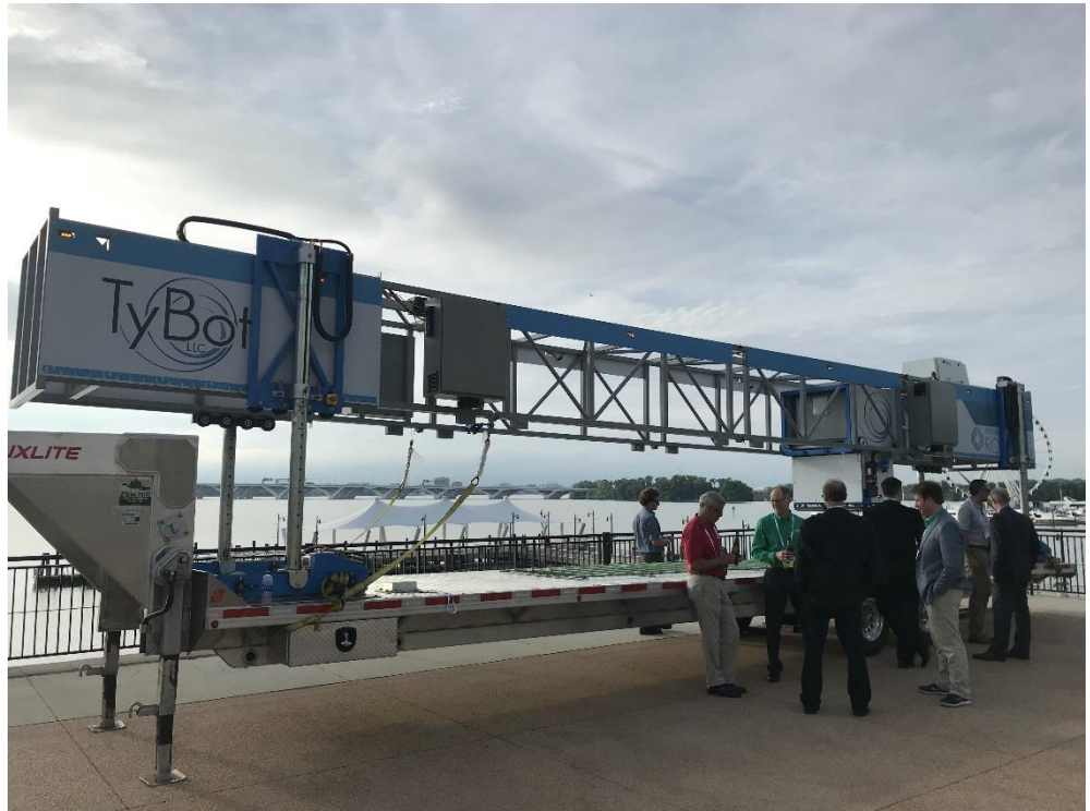
圖 3- 23 自動化橋面配筋機器人展示(Exhibition)
