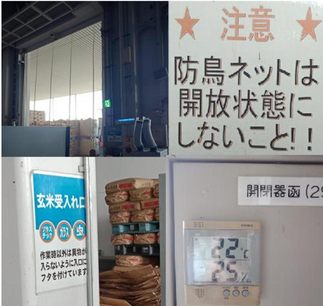
圖 21、「東洋ライス」工廠原料米進貨區之管制措施，包括防鳥網(左上圖及右上圖)、捕蟲燈(左上圖中之右下角)、進入筒倉之入口要加蓋以防異物(昆蟲、玻璃及塑膠等)混入之警語及該進貨緩衝區之溫濕度監控。
