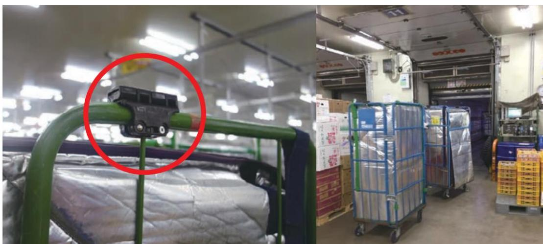
圖 29、「Nippon Access Inc.」物流中心導入 AGS 系統之臺車外觀，包括其上裝設之 RFID 天線(左圖)、臺車全貌及其出貨閘門(右圖)。註：本場次謝絕學員攝影廠區內部環境，本圖係擷取自日本 GS1 組織之公開資料<sup>1</sup>。
