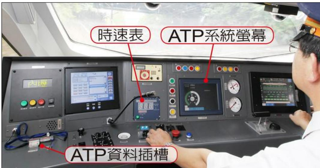
圖 3-6 BOMBARDIER ATP (EBI Cab 2000) 外觀圖
