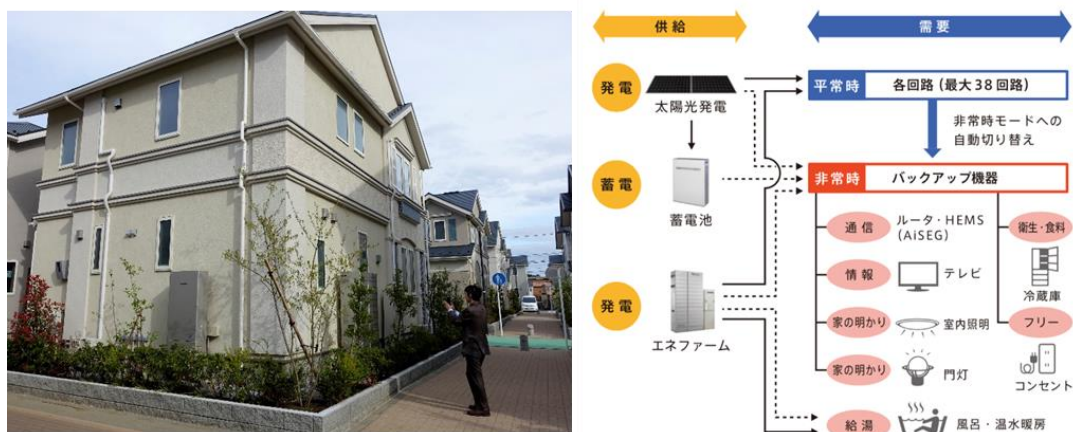
圖 12 獨棟式智能住宅與日常應用/應急備用電源系統概念圖
