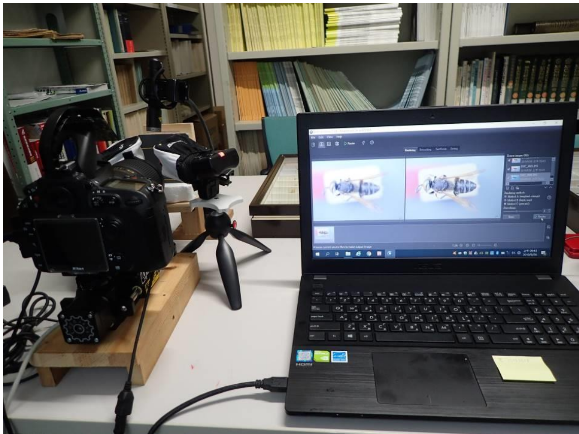
自行攜帶進行拍照的簡易設備與疊圖軟體
