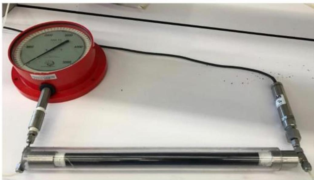
圖二、自製滲透率量測裝置
