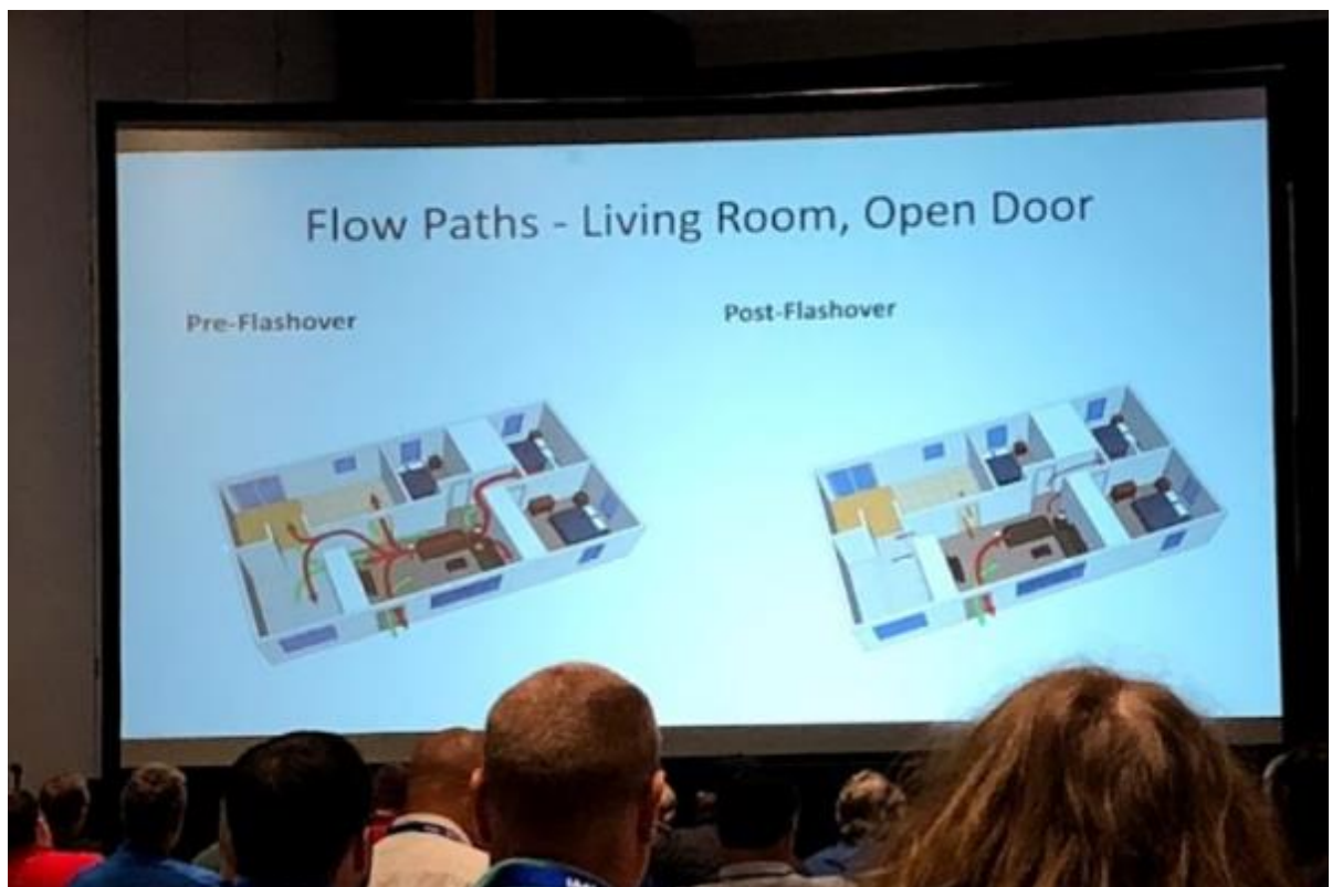
圖 10. 實驗 3、4 模擬燃燒火流示意圖(客廳大門打開)
