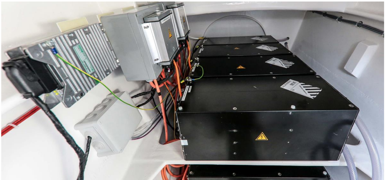
圖 29：Energy Observer 鋰離子電池 (資料來源：Energy Observer 官網 http://www.energy-observer.org/ )
