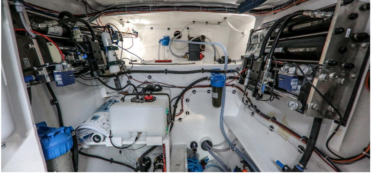
圖 30：海水淡化系統，運作效能為每小時 105 公升 (資料來源：Energy Observer 官網 http://www.energy-observer.org/ )
