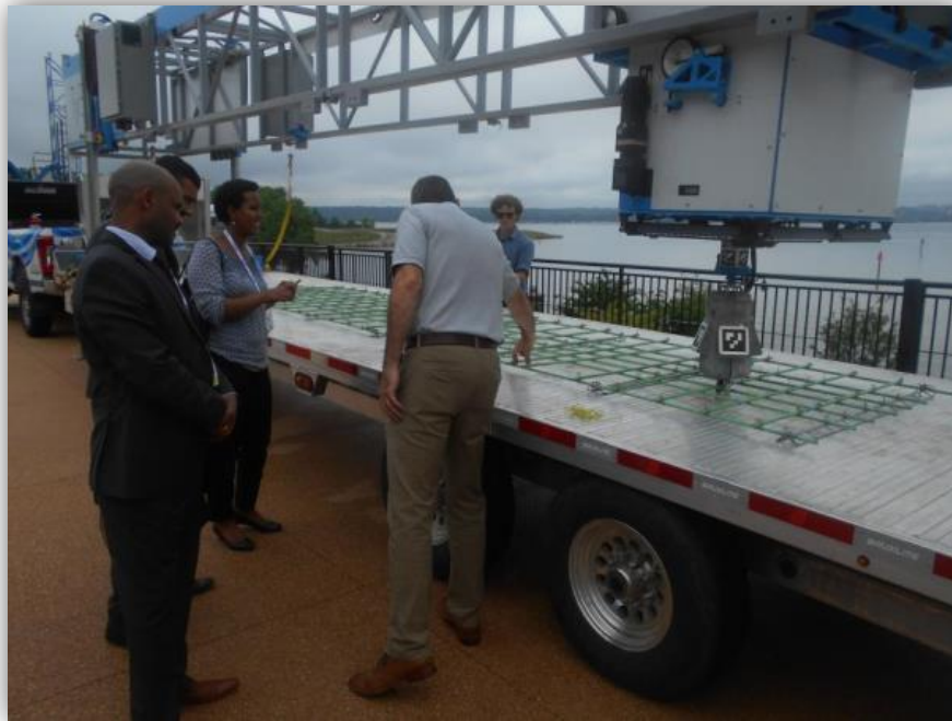
圖 15 鋼筋自動化綁紮機器展示會場
