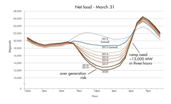
上圖為 CAISO 著名的鴨子曲線,由於再生能源將陸續併入電網中,扣除風力及太陽光電後之淨負載將持續降低,且在系統必須維持固定容量之強制運行機組(must run),將導致在從 2020 年之後出現過多電源之風險 · 2024 年白天時段之淨負載可能甚至為負值,此時除進行電源削減外 · 也必須搭配儲能設備來協助維持電力系統之平衡。為了使再生能源可整合進電力系統中 · CAISO 目前提出包括推動時間電價、需量反應、儲能等解決方案,並認為最終還是時間電價。
