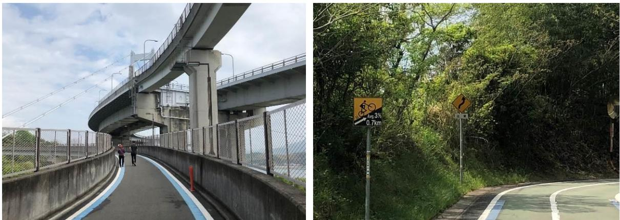
圖 15、通往跨海橋樑的連接道，坡度約 3%的設計
