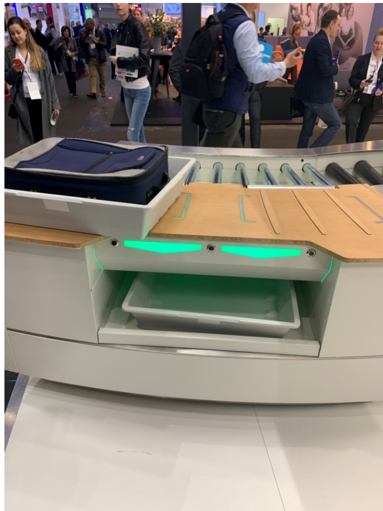
圖 7-手提行李輸送設備-5
