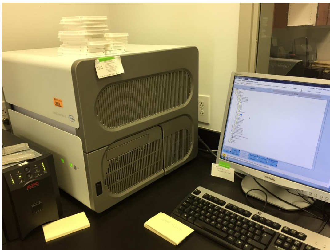
圖七、實驗室自 2016 年後主要轉成以 HRM 系統進行分子標誌鑑定，此系統具有快速、設計彈性大及成本較低等優勢。
