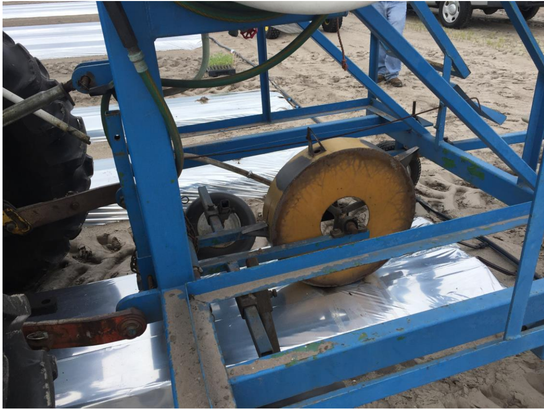
圖九、經篩選後的植株定植於田間，田間已由機械預先完成塑膠布、滴灌管鋪設及植床薰蒸，定植前以凸輪進行打洞及肥料或接種液灌注。
