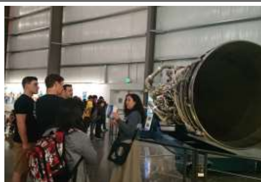
圖 5 液態氫、液態氧的混合燃燒為主引擎動力來源
