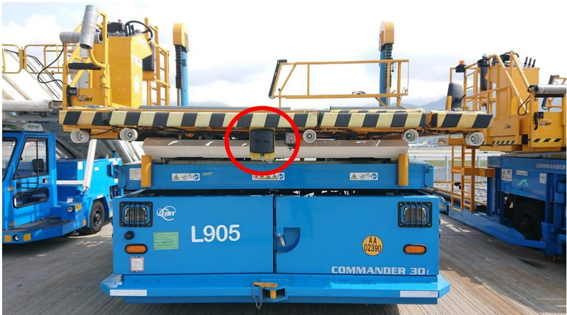
美製(JBT)裝卸平台車(圖中紅圈處為測距雷達)
