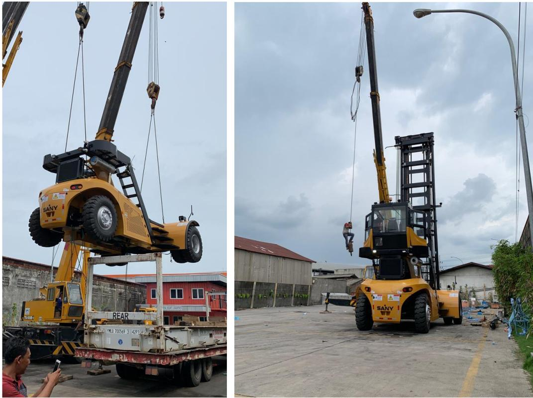
(圖八)空櫃堆高機現場吊掛組裝情形
