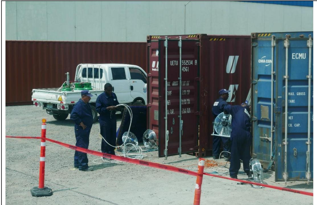
圖 9、Manzanillo International Terminals 之木材溴化甲烷燻蒸作業情形
