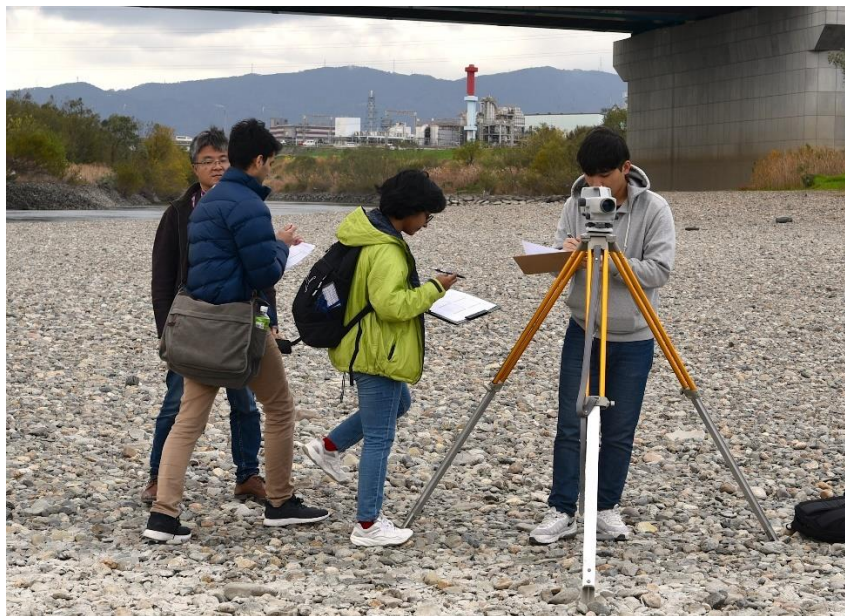
圖 41 量測水面水位高程差用以計算水利梯度
