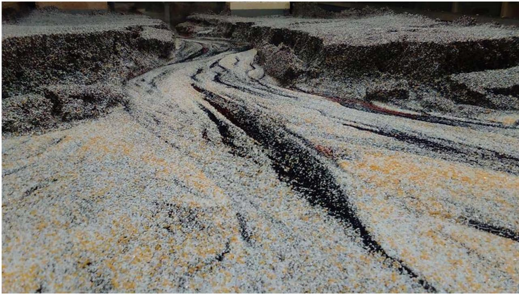
圖 47 使用小尺度模型模擬河道的擺盪變化
