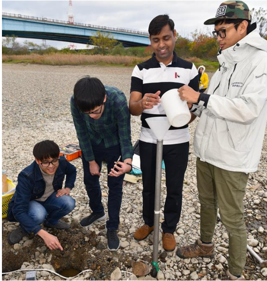
圖 42 注入鹽水(左)，量測導電度變化與計時(右)
