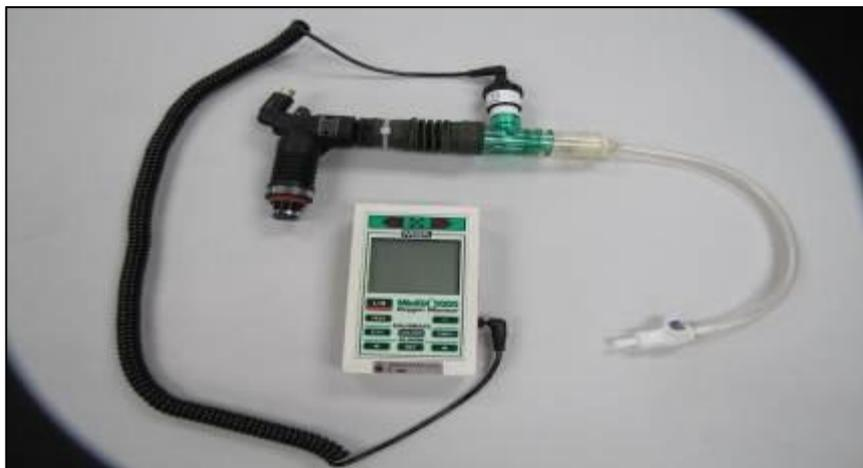
圖五 座艙氧氣系統手持式測試儀
