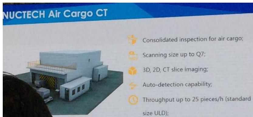
開發的安檢設備，利用電腦斷層(CT)技術提供 3D 立體成像，自動分析辨別危險物品警告安檢人員，相較於傳統 X 光機只能提供平面的二維圖像，且有可能遭金屬物品遮擋造成視野盲區，可大幅減少誤判率，而且此設備是專門針對空運貨櫃，可對整個貨櫃進行掃描(最大規格可達 Q7)，有效節省人力及時間，增進安檢運作效率。
