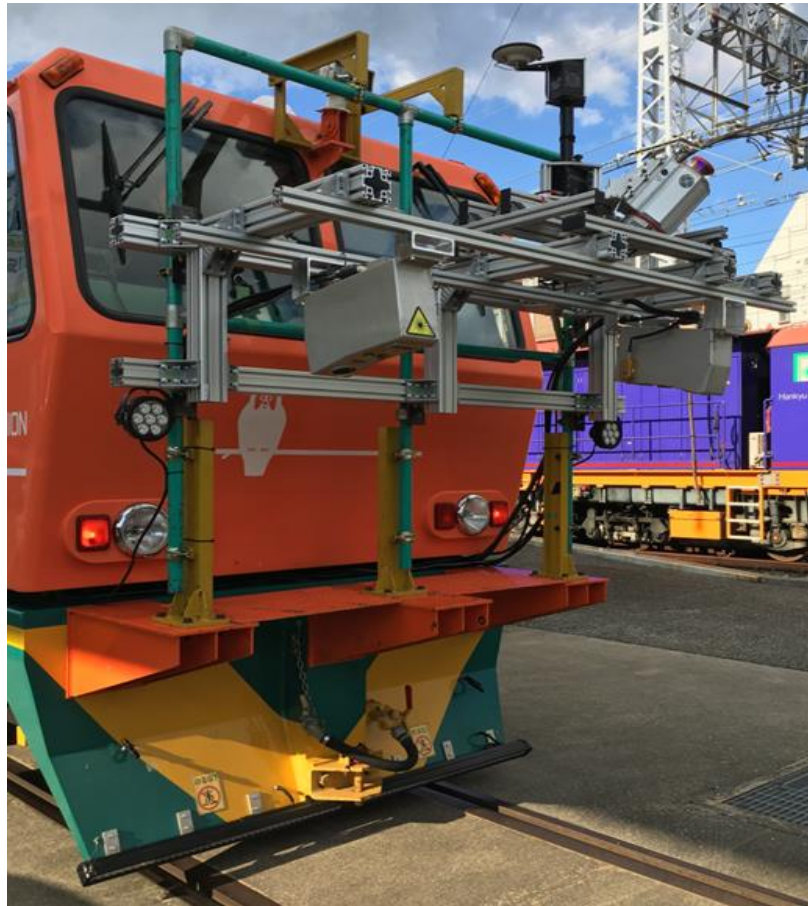
圖 2-29 主要設備安裝於軌道車之情況
