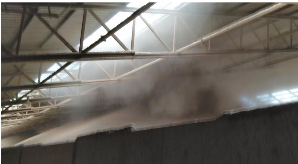
圖 46 Tripper Car 佈料機進料時引起極大揚塵現象
