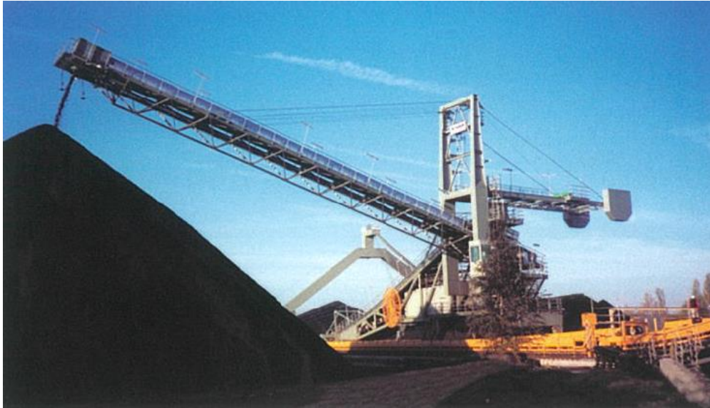
圖 44 俯仰式堆料機較適合戶外堆料場
