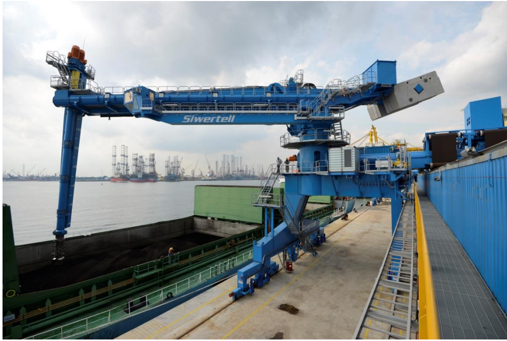
圖 11 螺旋式卸料機在密閉管道輸送燃料對環境較友善
