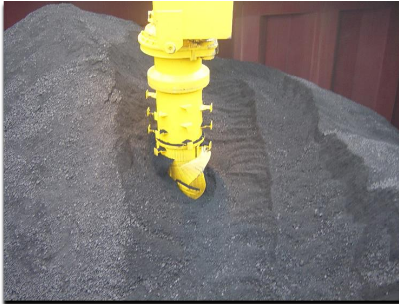
圖 7 卸料機自船艙取料照片
