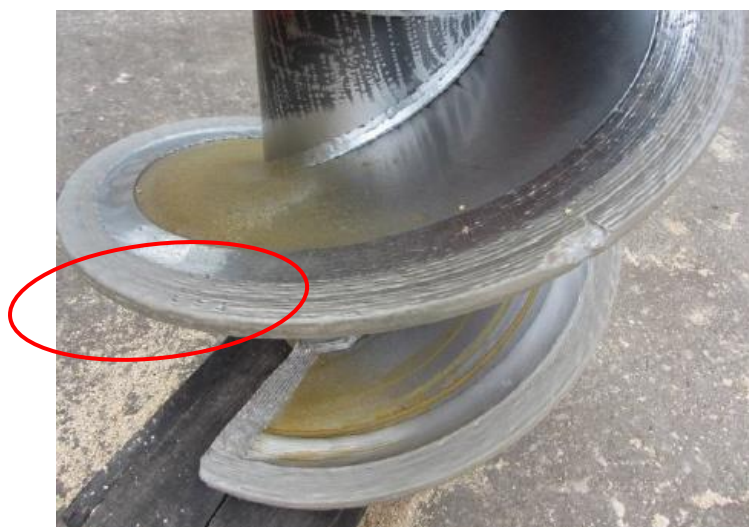
圖 22 螺旋葉片圓周區施以焊接被覆硬化層工法
