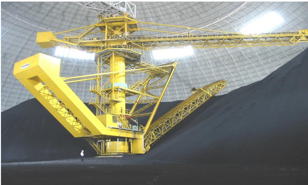
圖 42 圓型取料機適合應用於圓型室內儲煤場
