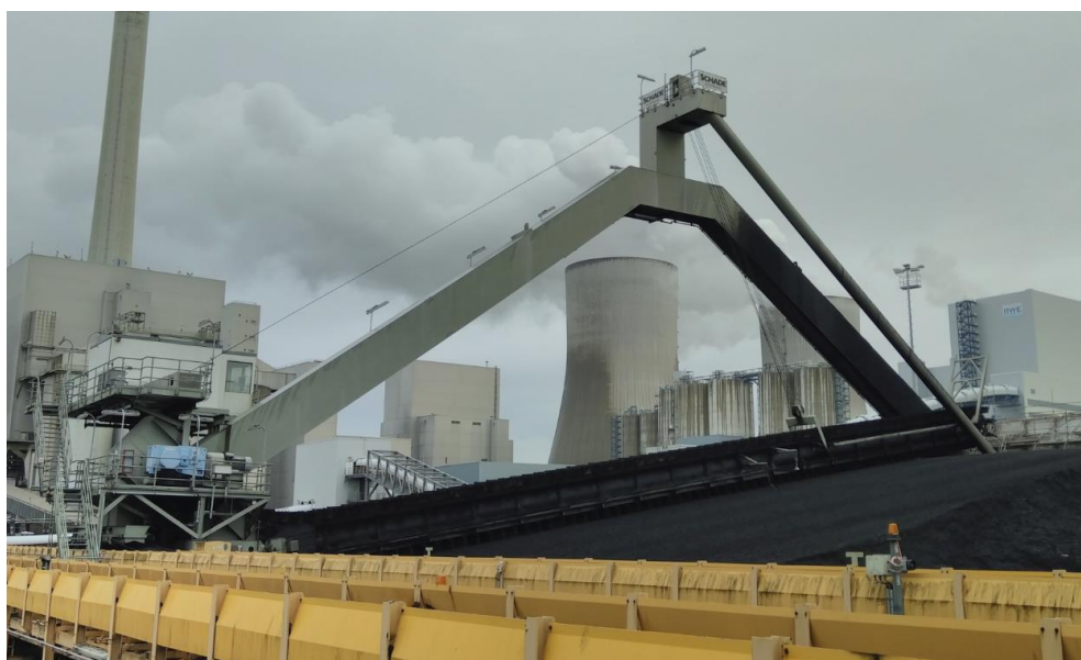
圖 40 全門型取料機適合應用於戶外儲煤場
