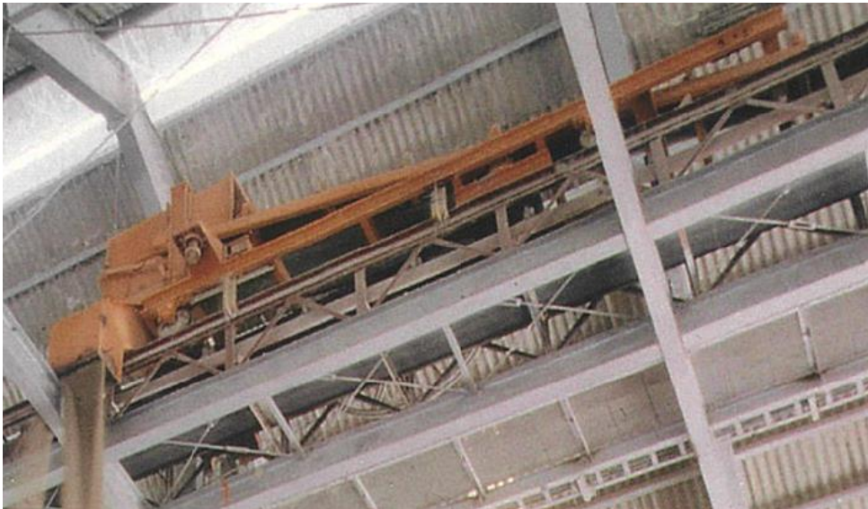
圖 45 Tripper Car 佈料機較適合室內儲料場
