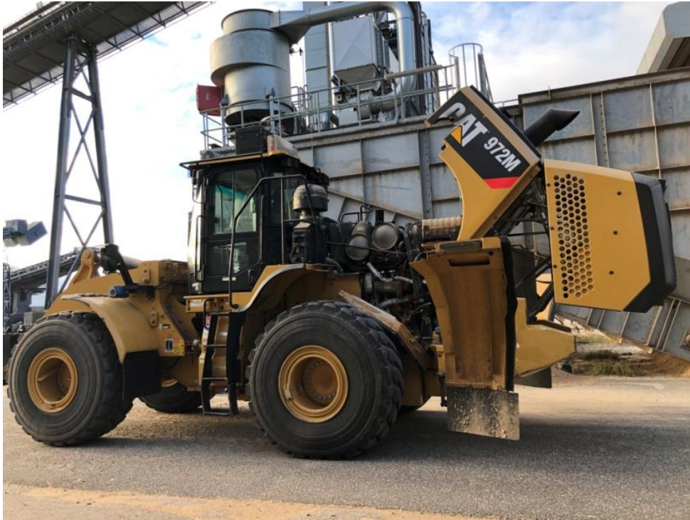
圖 36ATEX 防爆型鏟裝機
