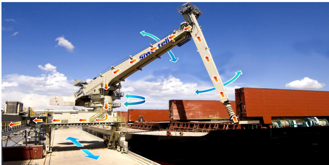
圖 8 螺旋式卸料機具有八個方向自由度特點
