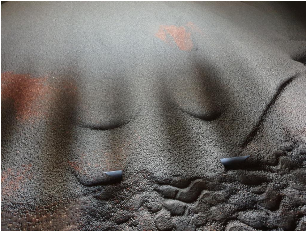
圖 35 取料過程之凹洞痕跡(木質顆粒)
