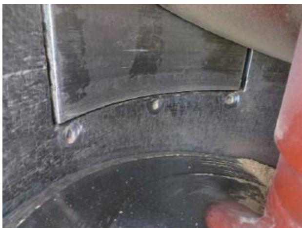
圖 13 OD Bearing 內部可更換磨耗片
