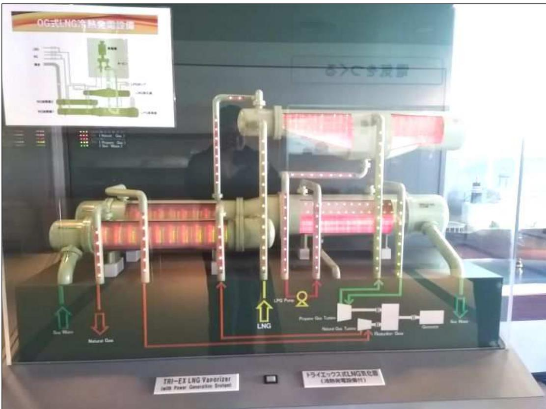
圖 7 OGC Cold Energy Power Generation 模型
