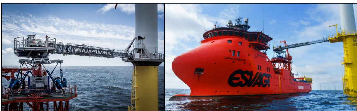
圖 11 OSV 上的 Walk-to-Work 系統
