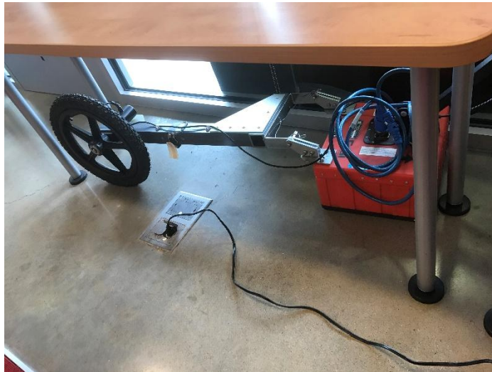
圖 39、雷達探測器，主要目的用於探測該地質成分是否有異常。
