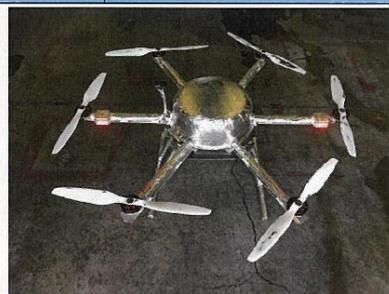
耐火構造として外観をアルミ、耐火服素材、耐火塗装で加工
