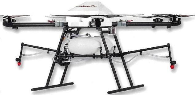
農業での液剤散布機としてすでに実績を持っているAC940-Dのノウハウを元にタンクの容量を9リットルと大幅に増やし、より使い勝手の良さを追求したモデルとして登場しました。もちろんオプションで粒剤散布装置も用意。フレームを交換するだけなので、僅か数分という驚きの手軽さで粒剤散布機に早変わりします。
