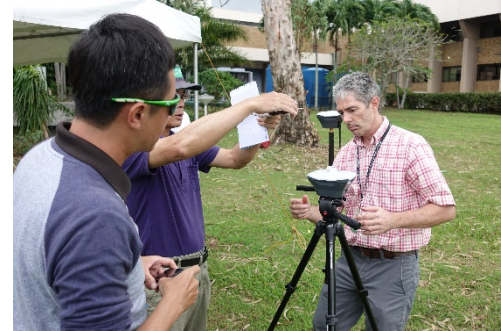
圖 10、利用區域 UTM 輔助系統以 GPS 原理進行高度精確的量測\
