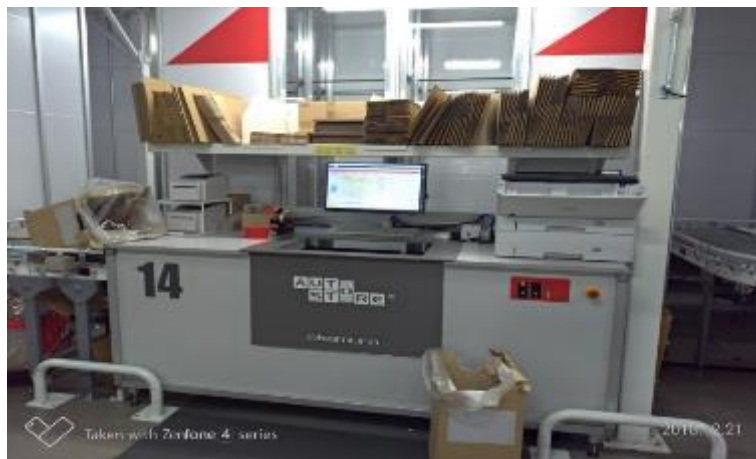
圖 29：Moving 人員揀貨包裝操作檯，後方即為 AutoStore 本體
