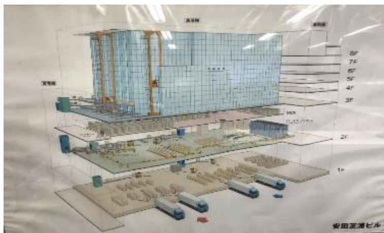
圖 18：安田 DC 倉庫自動倉儲樓層構面
