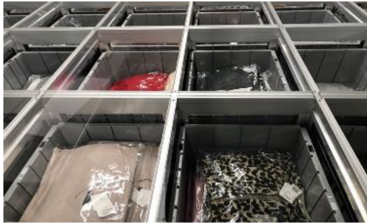
圖 28：Moving-AutoStore 儲存貨架，垂直堆疊可達 5 公尺
