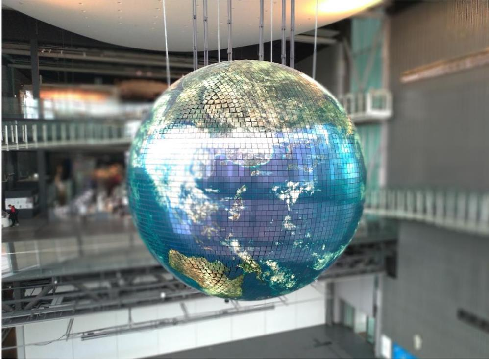
懸吊於 Miraikan 的球體 Geo-Cosmos 是該館的入口形象標記，模擬從太空探見藍色地球的氛圍，為全球首次使用 EL 面板的球體顯示器。
