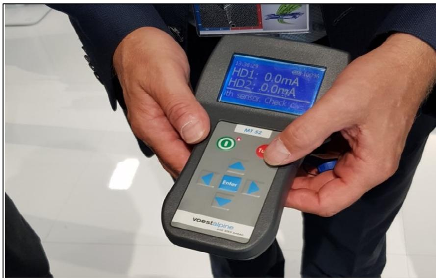
圖 16 以手持式裝置調整計軸器數值
