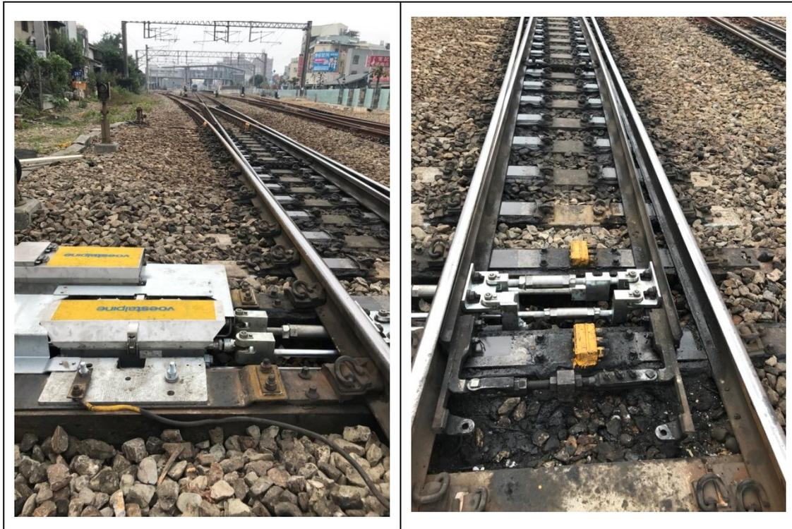
圖 8 臺鐵所採購之防水型電動轉轍器
