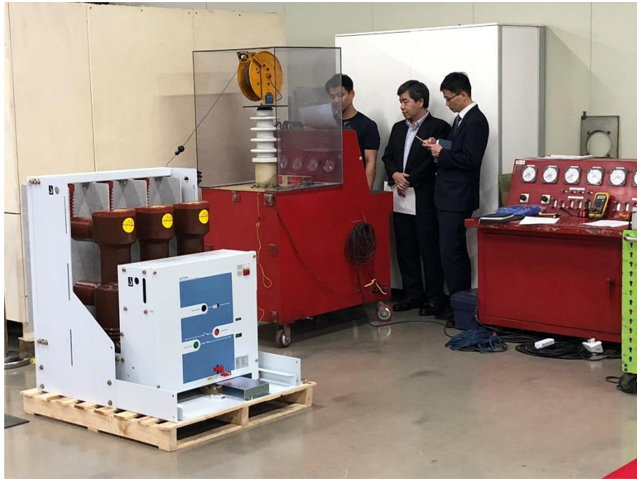
圖 15 主回路商頻耐電壓試驗
