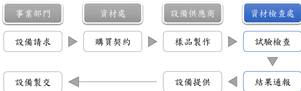
圖 23 KEPCO 採購與試驗檢查流程
