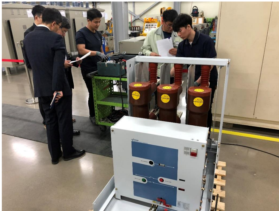
圖 14 主回路電阻量測
