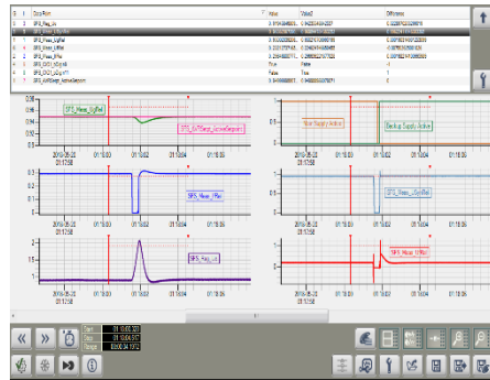
圖 4-32 主勵磁電源消失測試
