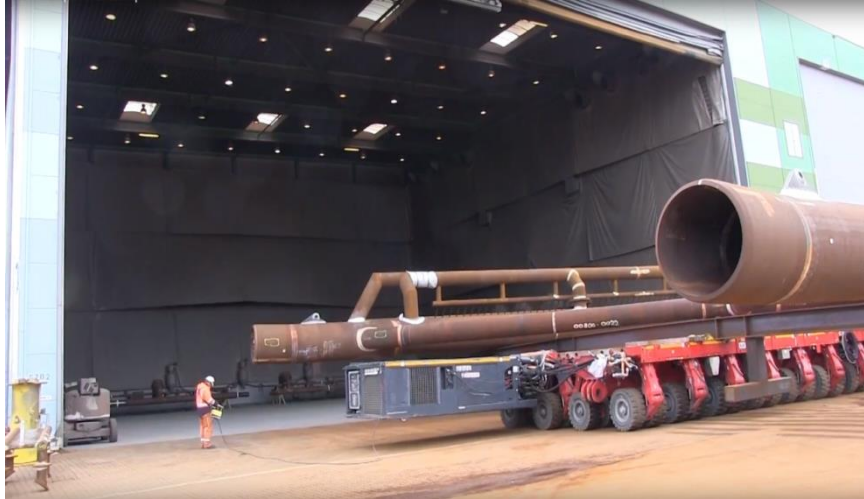
圖 13BWS 以其自有 SPMT 運輸水下基礎構建 (圖片源自 BWS 提供)
