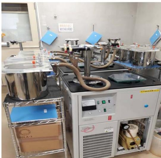
圖 4 生物樣品氚低壓凍結乾燥機
