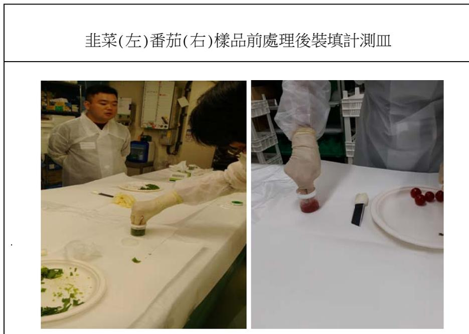
預防樣品膨脹以塑膠環固定計測皿中樣品高度
